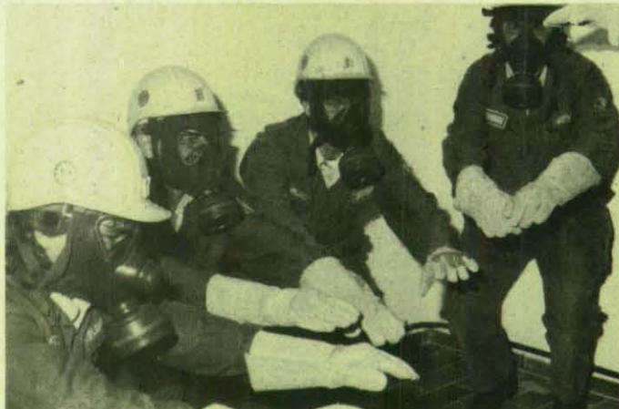
Testen ob die Tränen kommen: Mit Reizgas wird die Dichtigkeit der Maske geprüft.
