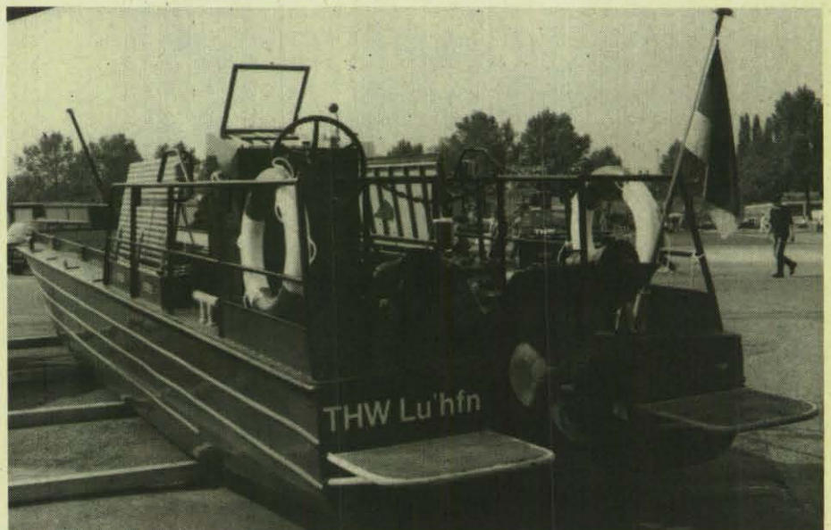
Ein Leckerbissen der Technik-Schau ist dieses Mehrzweckboot des THW-OV Ludwigshafen, das als Schubboot eingesetzt werden kann. Länge 12,50 m, Breite 2,40 m, Tragfähigkeit 2,3 t, Motor 135 PS Diesel (MAN).
