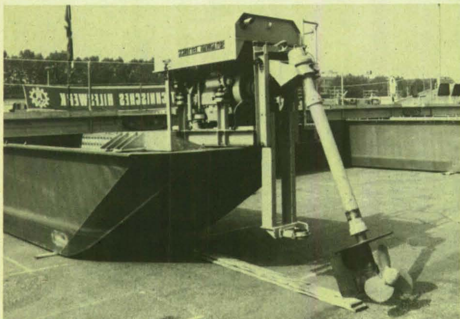
Ein „schwerwiegender“ Antrieb für eine 40-t-Fähre: Ein Schottel-Navigator, 4 Zyl. Diesel (KHD), 63 PS/1300 Umdrehungen.
