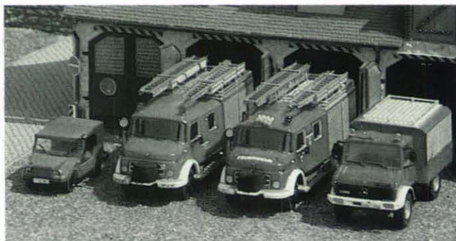
Löschgruppenfahrzeuge 16-TS im Zugverband des LZ-R (v.l.n.r.): Zugtruppenfahrzeug (nach STAN zu beordern), zwei LF 16-TS der Löschgruppen, RW 1 des Rettungstrupps.
