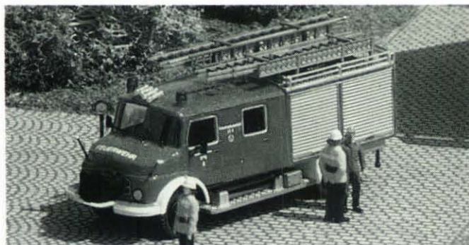
Unser Modell zeigt ein Fahrzeug aus dem Landkreis Bayreuth: Etwas abweichend von der Normausstattung sind die Frontbeschriftung und die Tonfolgehörner auf dem Fahrzeugdach.
