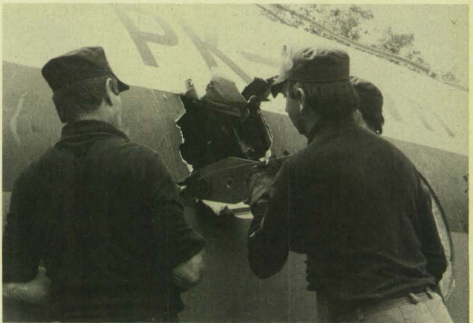
Mit Hilfe einer hydraulischen Schere wird das Heck des Flugzeugs aufgeschnitten.
