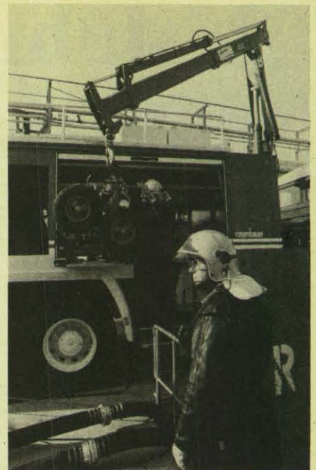
Der bordeigene Ladekran wird auch zum Ablassen der Tragkraftspritzen genutzt.
