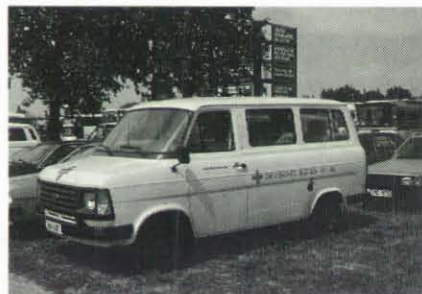
Der Sanitätsgruppenkraftwagen (SanGrKw) auf Ford Transit in der gängigen Ausführung. Die organisationseigenen Beschriftungen können in unterschiedlicher Form aufgebracht sein.
