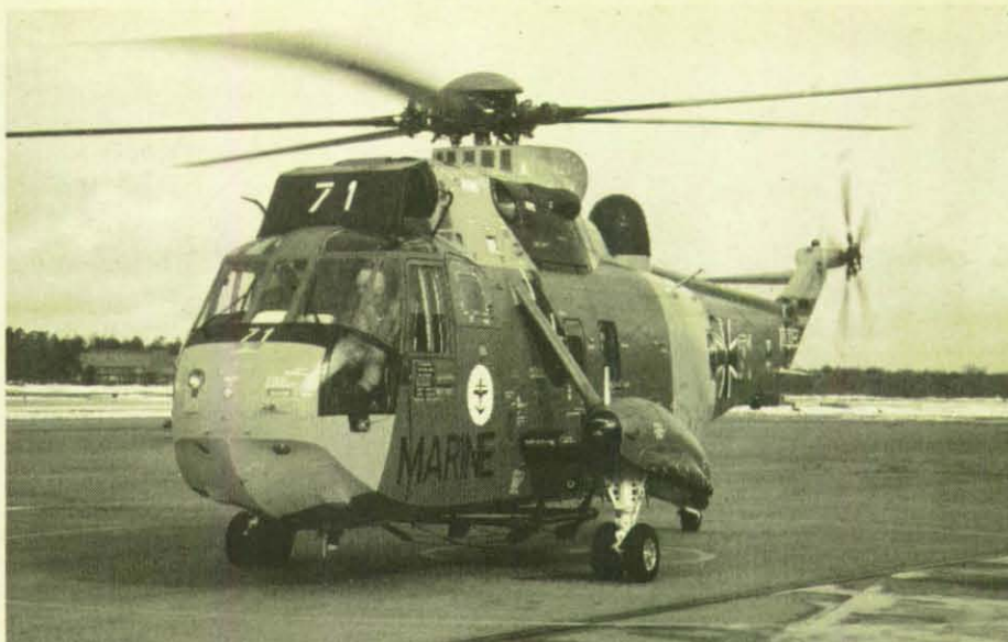
Eine Sea-King vom Marinefliegergeschwader in Kiel: Ein Hubschrauber mit Hoverautomatik und Navigationsradar ist voll seeflugtauglich.
