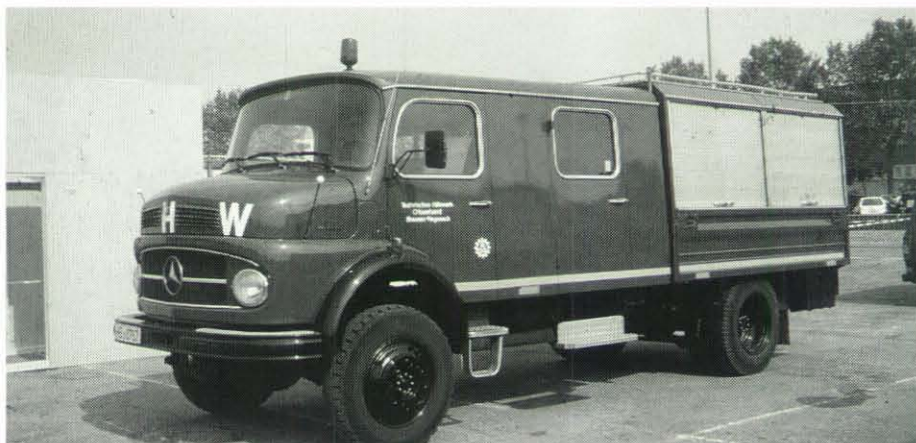
Unser Vorbildfahrzeug: der MKW des THW-Ortsverbandes Bremen-Vegesack, eine Fahrzeugausführung mit orange-farbenem Seitenstreifen und Dachblaulicht. Interessant auch die zusätzlichen Reflektoren an den Fahrzeugseiten. Die zwei Peilstangen auf der Motorhaube müssen beim Modell ergänzt werden – sie sind im Bausatz nicht enthalten (siehe auch „Detaillierung“!).
