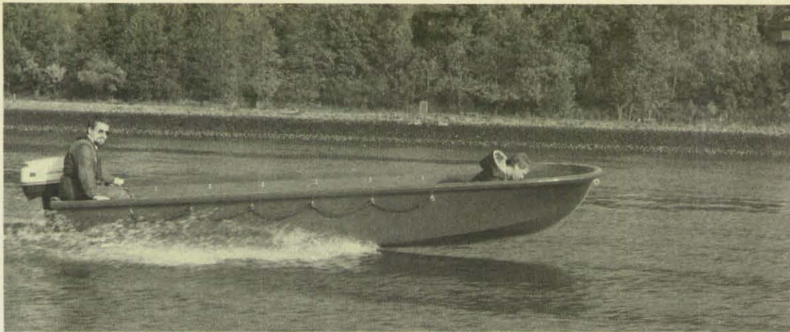
Das THW setzt ein Mehrzweckboot (A-Boot) aus Kunststoff ein. Ein K-Boot und zwei A-Boote bilden eine Dreiereinheit.
