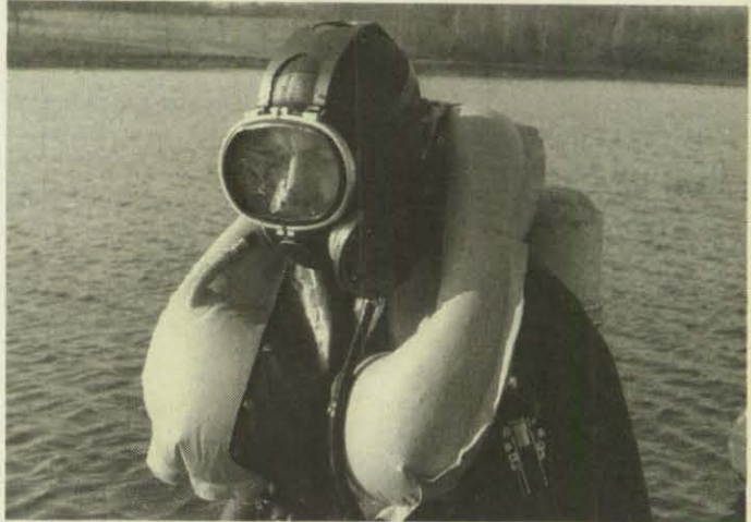
Der Tauch-Ret-tungskragen bringt den Taucher im Falle der Gefahr schnell an die Wasserober-fläche.
