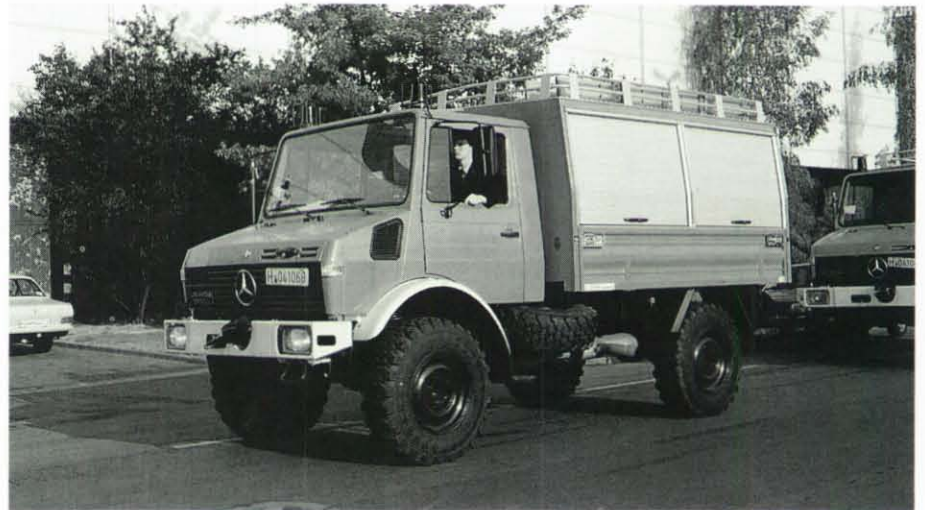
Ein RW 1 des Katastrophenschutzes auf Mercedes-Benz-Unimog mit Wackenhuth-Aufbau. Es handelt sich hier um den bekanntesten Typ des KatS-Rüstwagens.
