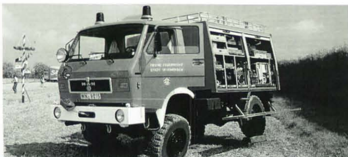
Weniger bekannt ist die Version auf MAN/VW 8.136 (hier ein Fahrzeug der FF Winnenden). Auch im Modell kann der RW 1 offen dargestellt werden; das Foto zeigt zudem die für den Umbau wichtigen Details am MAN/VW-Fahrerhaus.
