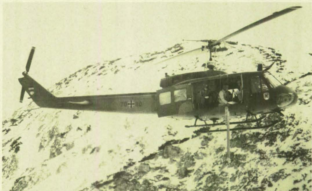
Am „Galgen“ des Hubschraubers hängt die Sprengladung mit dem Holzpflock, der nach dem Ausklinken im Schnee steckenbleibt, damit die Sprengwirkung erfolgreich ist.
