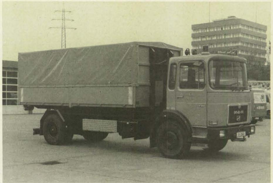
Bild 2: Der komplette, transportbereite AB-Dekon mit WLF.
