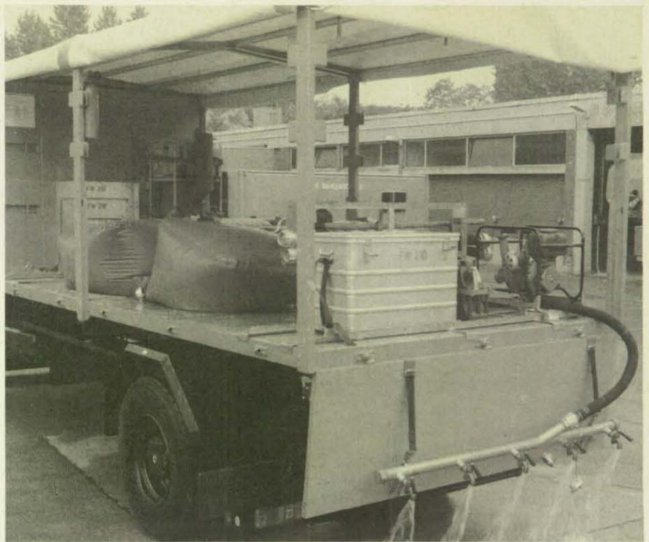
Bild 5: Der AB-Dekon als TW 30 umgerüstet.
