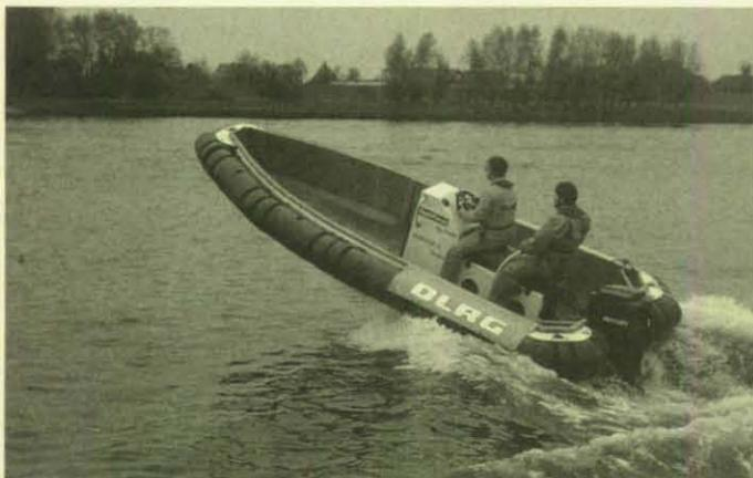
Auch bei schnellster Beschleunigung und bei harten Wellen gibt der Sattel des Task-force-Bootes guten Halt.
