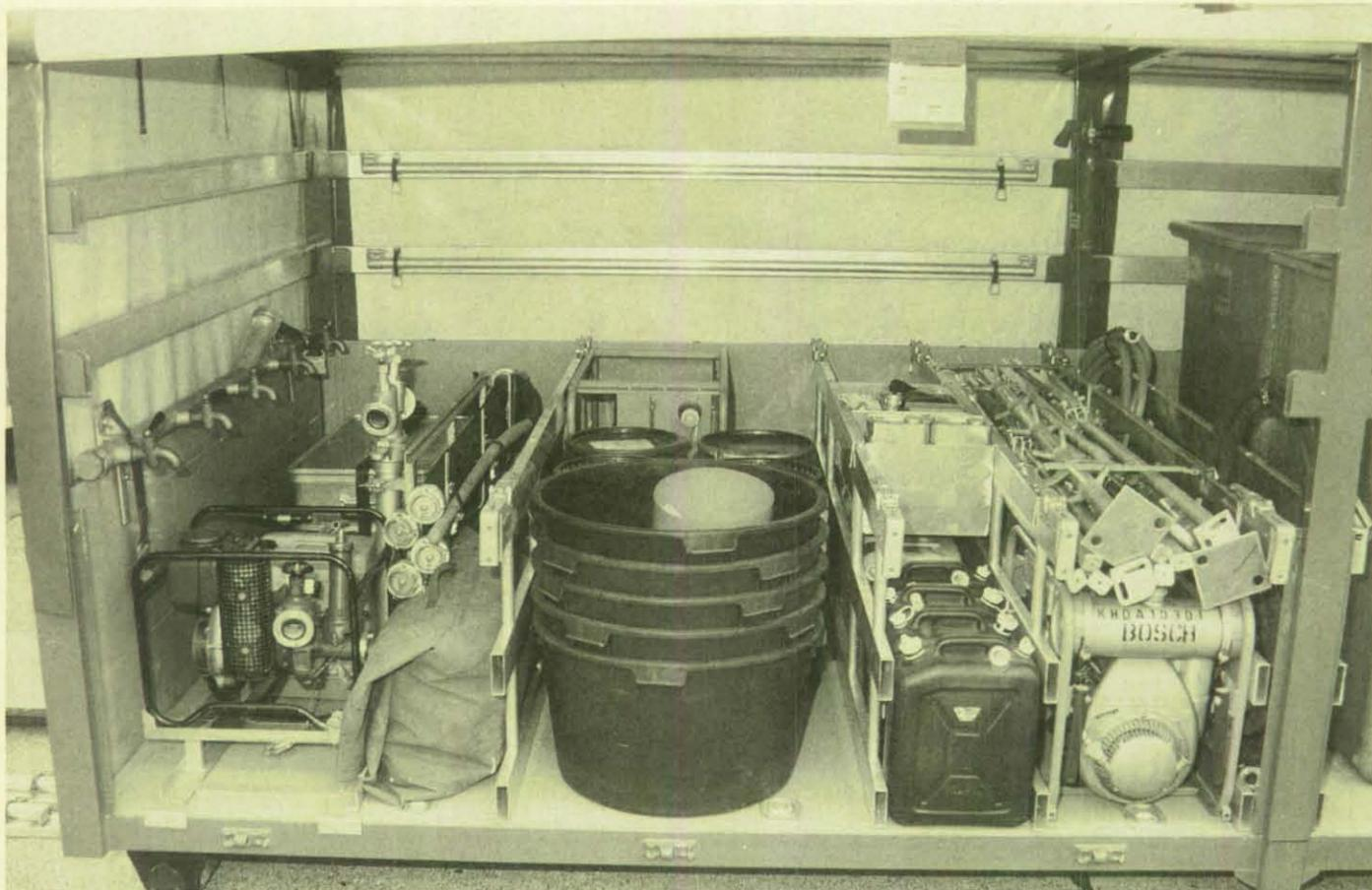
Bild 4: Blick in den geöffneten AB-Dekon (rechte Seite).
