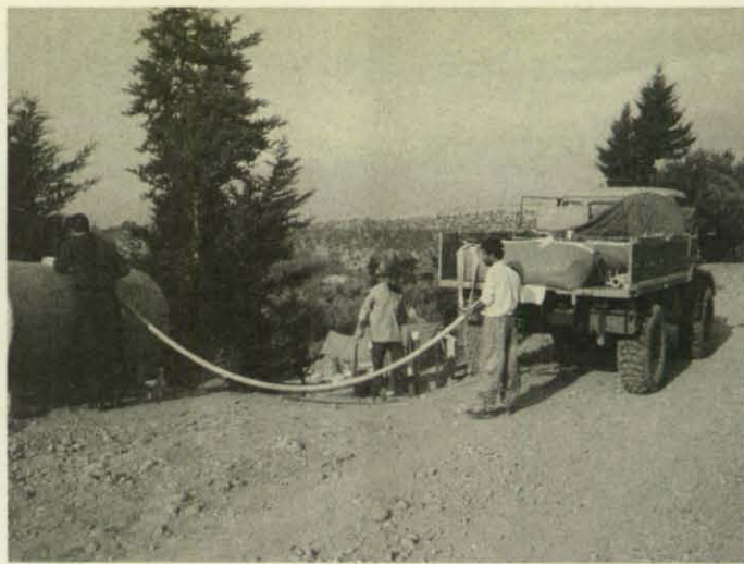
Mit dem zum Tankwagen umgerüsteten Unimog konnten auch die hochgelegenen Gebirgsdörfer mit Trinkwasser versorgt werden. (Fotos: Hamburg)
