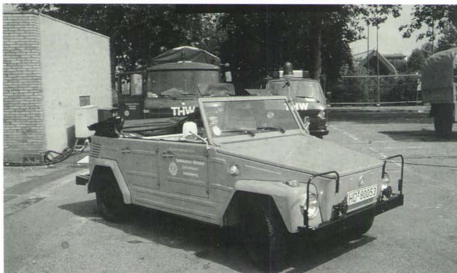
Erkundungskraftwagen (ErkKW) des ABC-Zuges im THW Heidelberg – der VW 181, hier mit herabgelassenem Verdeck, wurde vom Bund an die Katastrophenschutzeinheiten ausgeliefert. Zur Beachtung die Blaulichtanlage und die Schutzgitter an den Fahrscheinwerfern.
