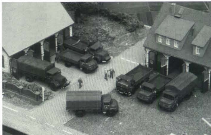
Eine Auswahl Lkw beim THW (v. l. n. r.): MAN (ehem. Bundeswehr), MB 1113 (Einspurbereifung), MB 1217, MB 1113 – Kipper, MB 1113 (Zwillingsbereifung). Oben links zwei Sonder-Lkw mit Ladekran.
