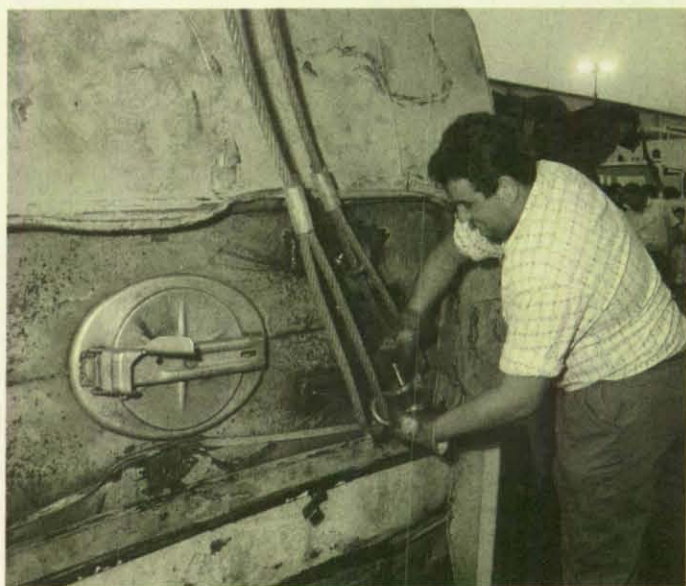
Serienmäßig angebrachte Bergeösen erleichtern das Aufrichten eines umgekippten Tankfahrzeuges. (Werkfoto: Willig)
