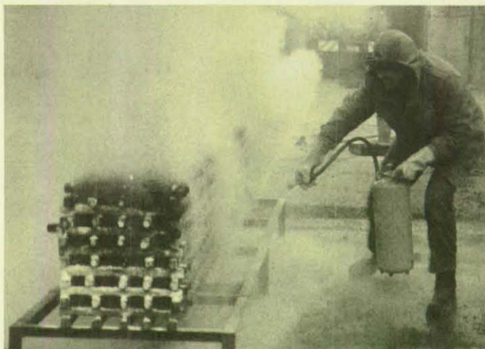
Ein Brandversuch mit Ottokraftstoff auf vier Quadratmeter Oberfläche mit einem 12-kg-Pulverlöscher.
