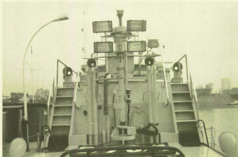
Mit der ausfahrbaren Lichtgiraffe lassen sich Einsatzstellen weiträumig ausleuchten.
