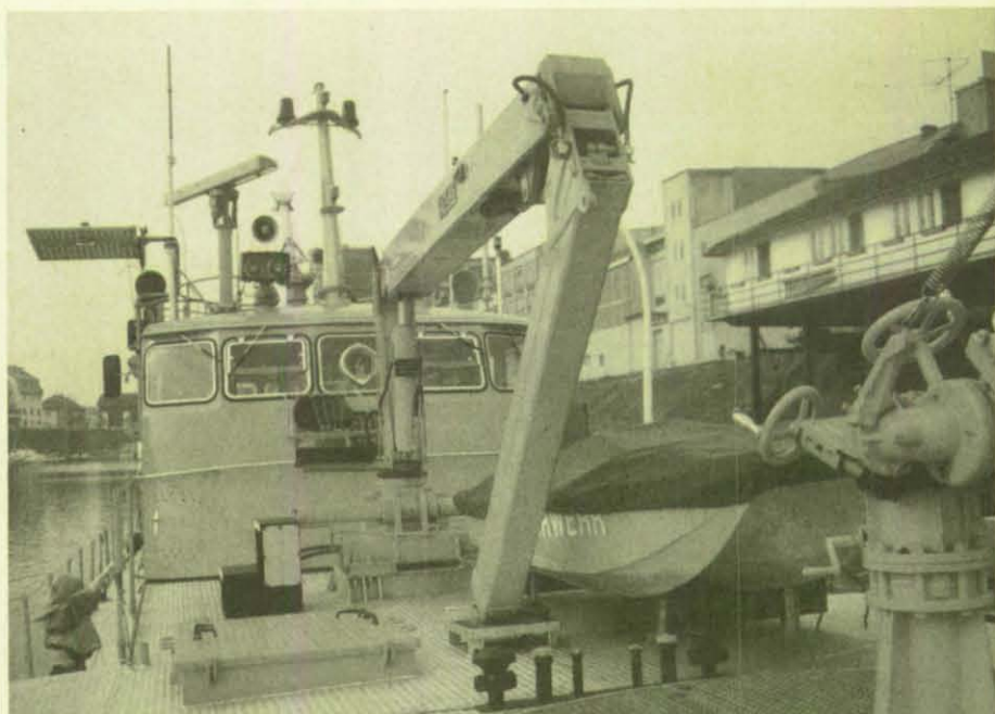
Der Kran vor dem Ruderhaus hat eine Hubkraft von zwei Tonnen.
