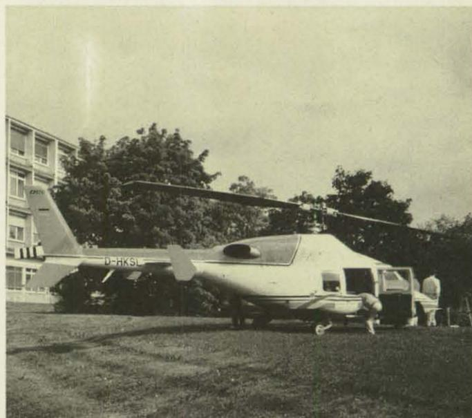
Der neu vom ASB eingesetzte Ambulanzhubschrauber vom Typ „Bell 222“ ist blindflugtauglich und kann 500 km entfernte Einsatzorte erreichen.
