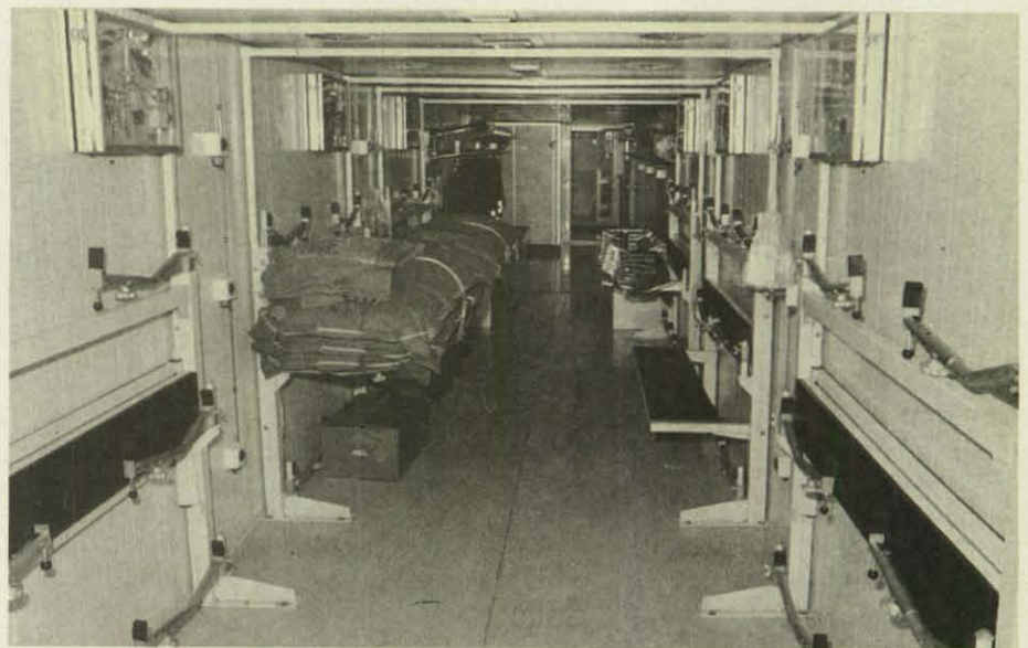
Mit dem Transportwagen 2 können 60 bis 80 Verletzte liegend aus dem Tunnel gefahren werden. (Fotos: Holz)
