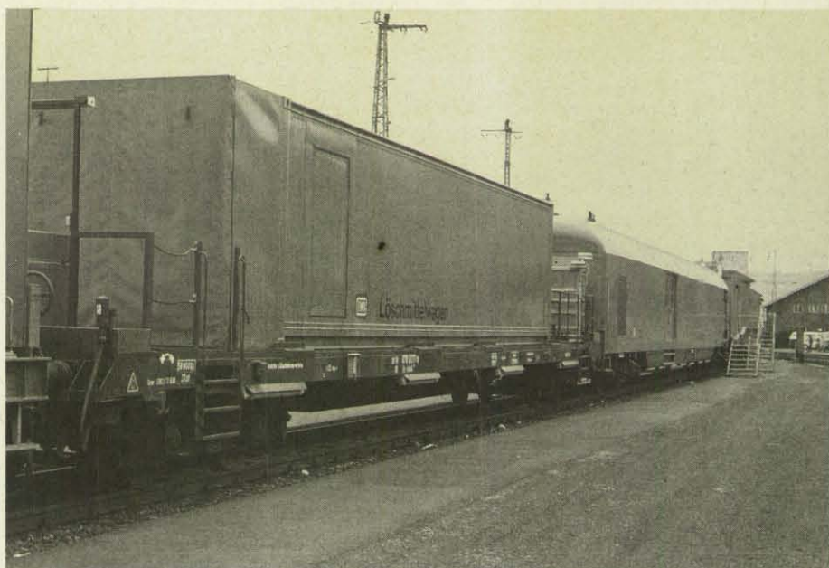
Der Löschmittelwagen und der Gerätewagen, in dem die feuerwehrtechnische Ausstattung mitgeführt wird.
