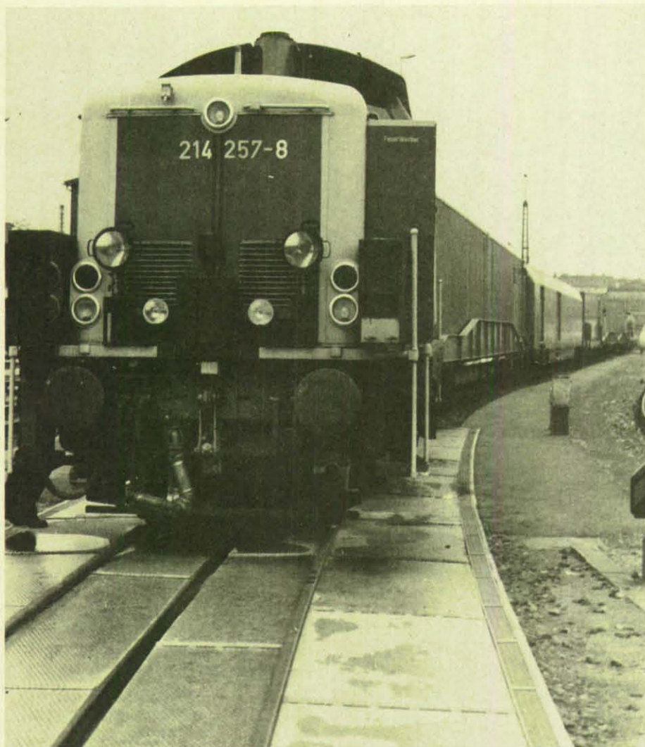
Frontansicht der führenden Lok 1 mit Videokamera (rechts) und Wärmebildkamera (links).
