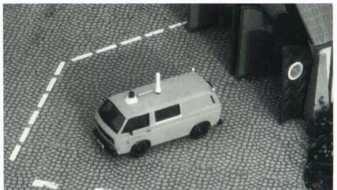
AC-Erkundungskraftwagen im Maßstab 1:87 – neben der Warnanlage zeigt sich deutlich die auf das Dach aufgesetzte Meßanlage.
