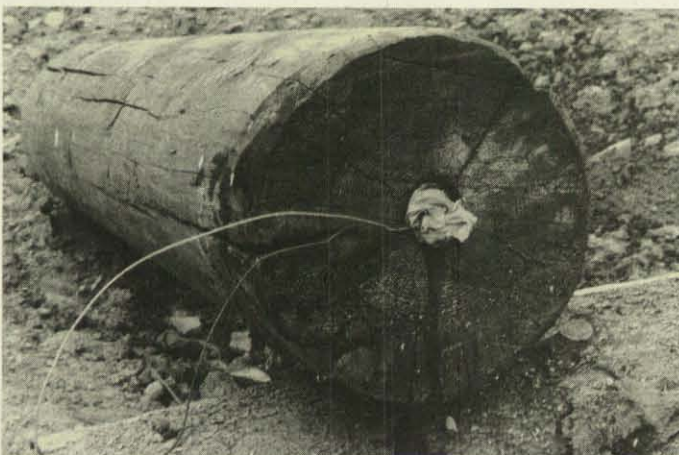
Eingebrachte Sprengladung in ein Rundholz.
