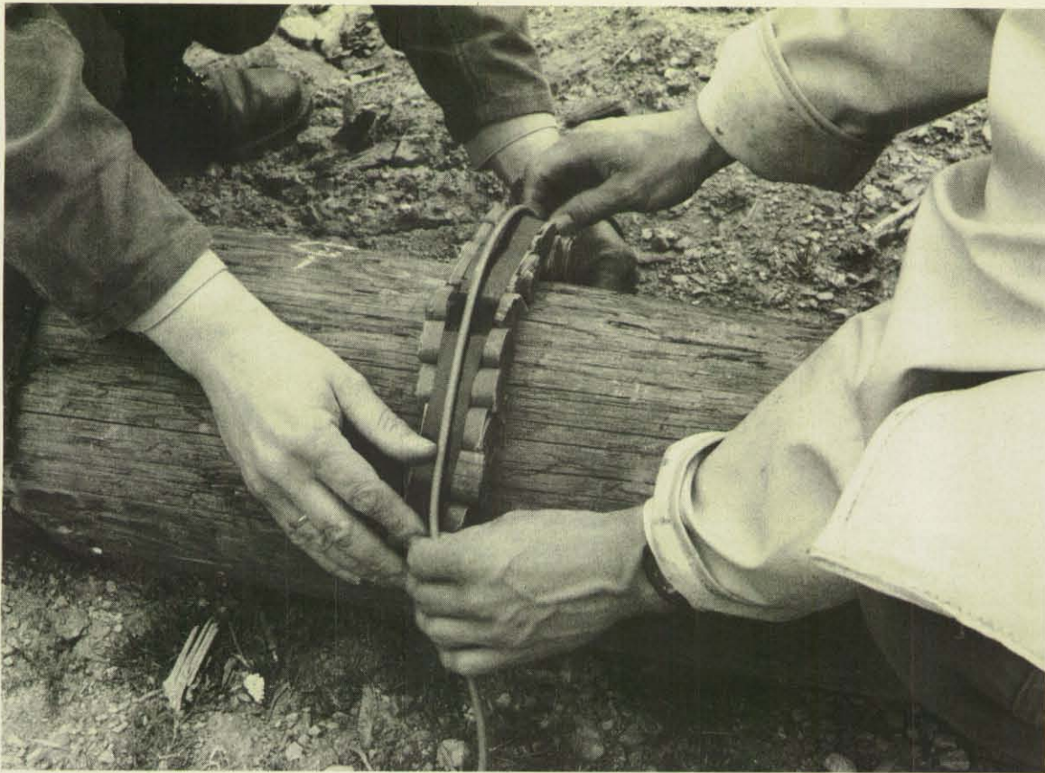
In Patronengurtform wird eine Ladung an ein Rundholz angelegt.
