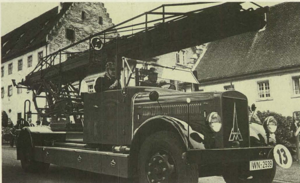
Magirus Drehleiter DL 18 der Berufsfeuerwehr Stuttgart, die heute im Feuerwehrmuseum Winnenden im Rems-Murr-Kreis steht. Der dreiteilige Holzleitersatz für Handbetrieb war ursprünglich auf einem Anhänger und wurde 1938 auf das Magirus-Fahrgestell aufgebaut. (Foto: Stolz)
