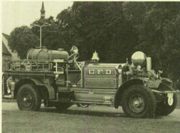
Das älteste Fahrzeug, das an der Rundfahrt teilgenommen hat: Die Ahrens-Fox von 1916, die im Auto + Technikmuseum in Sinsheim steht. Sie wird auch „Rolls-Royce der Feuerwehrautos“ genannt. Vor der Motorhaube sitzt die Kolbenpumpe (3000 l/Min.) mit dem kugelförmigen Windkessel. In Europa beschaffte nur die Rotterdamer Feuerwehr die teuren Ahrens-Fox-Feuerwehrfahrzeuge. (Foto: Breuer)
