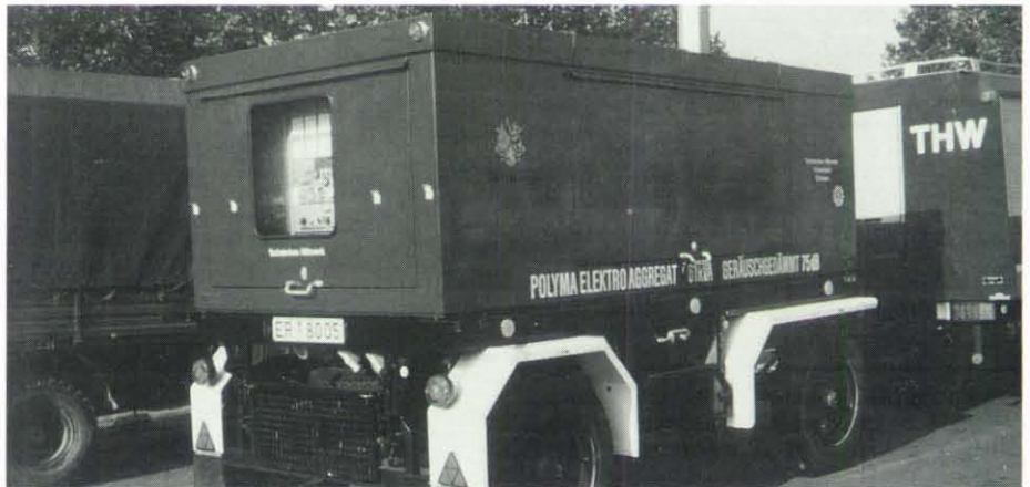
Das Vorbild für unser Modell: Notstromaggregat 61 kVA des THW Erlangen. Zur Beachtung die im Heckfenster sichtbare Armatur, die auch im Modell dargestellt werden kann.
