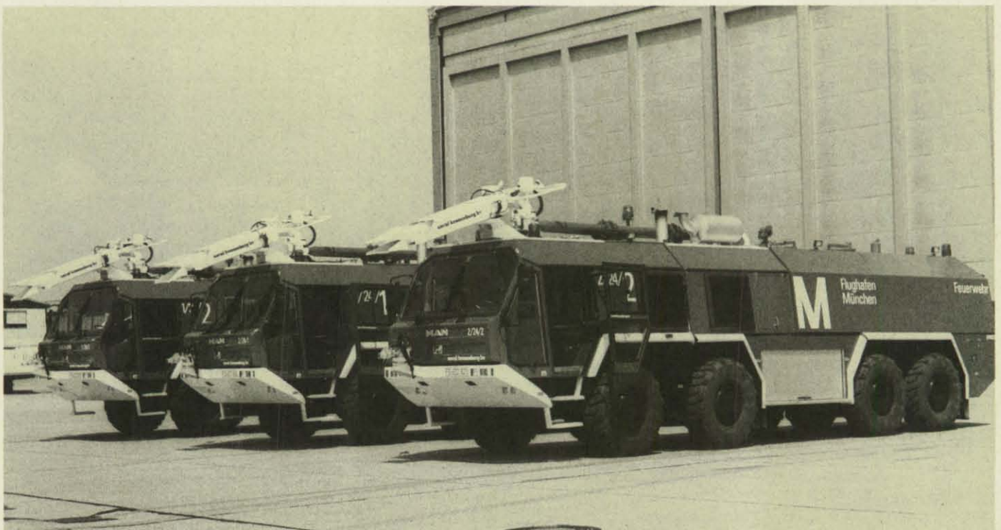
Drei der neuen vierachsigen, je 36 Tonnen schweren Wasser-/Schaumfahrzeuge der Münchner Flughafenfeuerwehr.
