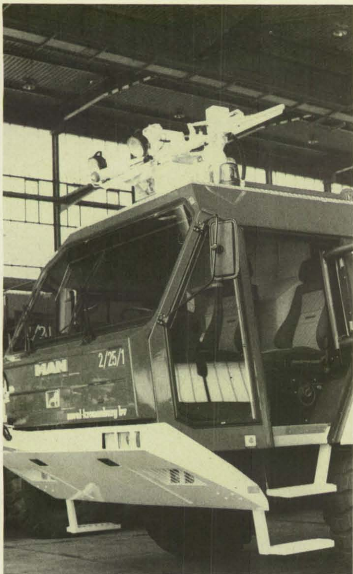
Links: Blick ins Fahrerhaus: Der Fahrer sitzt in der Mitte, die Türen schließen automatisch.
