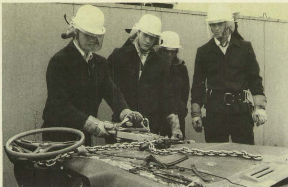
Das Lenkrad wird mit Hilfe einer Kette und dem hydraulischen Spreizer nach vorne gezogen.
