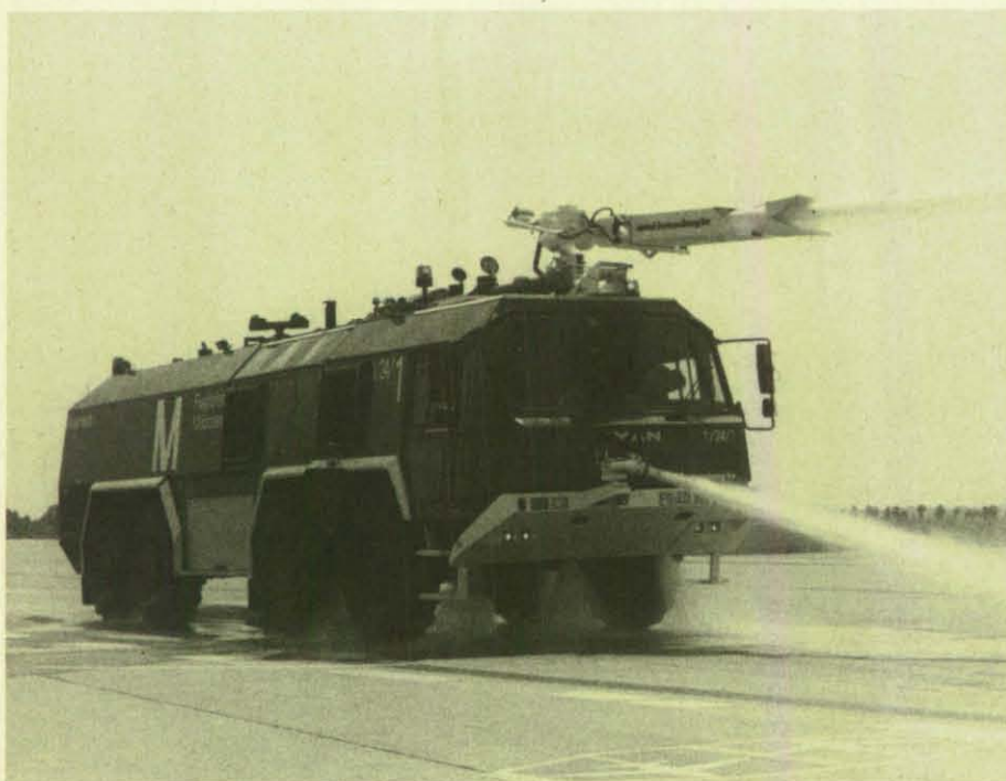
Wasser aus allen Rohren – Dach- und Frontwenderohr in Aktion.
