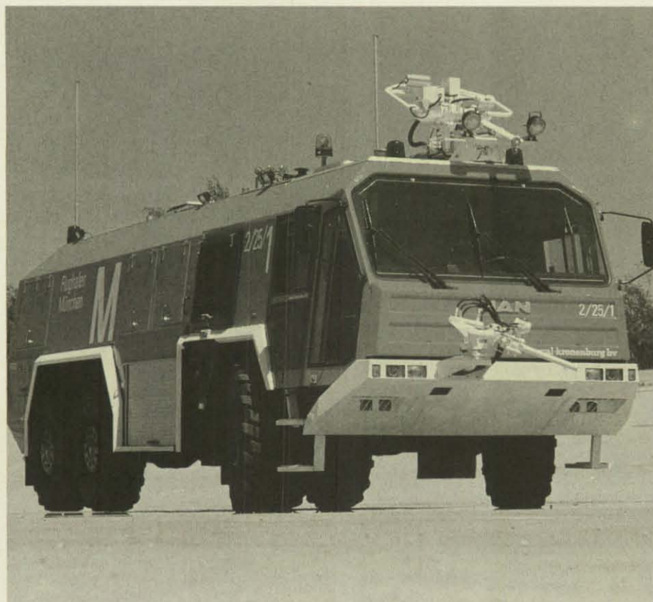
Unten: Der „kleinere Bruder“ als Pulverlöschfahrzeug transportiert vier Tonnen Pulver, notfalls mit Tempo 140. (Fotos: pewe 4, MAN 1)
