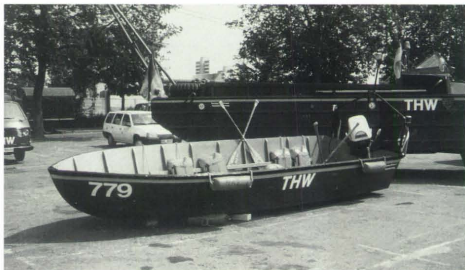
Vorbild eines MZB, wie es dem Hochwasseralarmzug Rheinland-Pfalz zur Verfügung steht, mit Schiffsfahrts-Beleuchtungsanlage (hinten), Paddeln, Schwimmwesten und Außenbordmotor.
