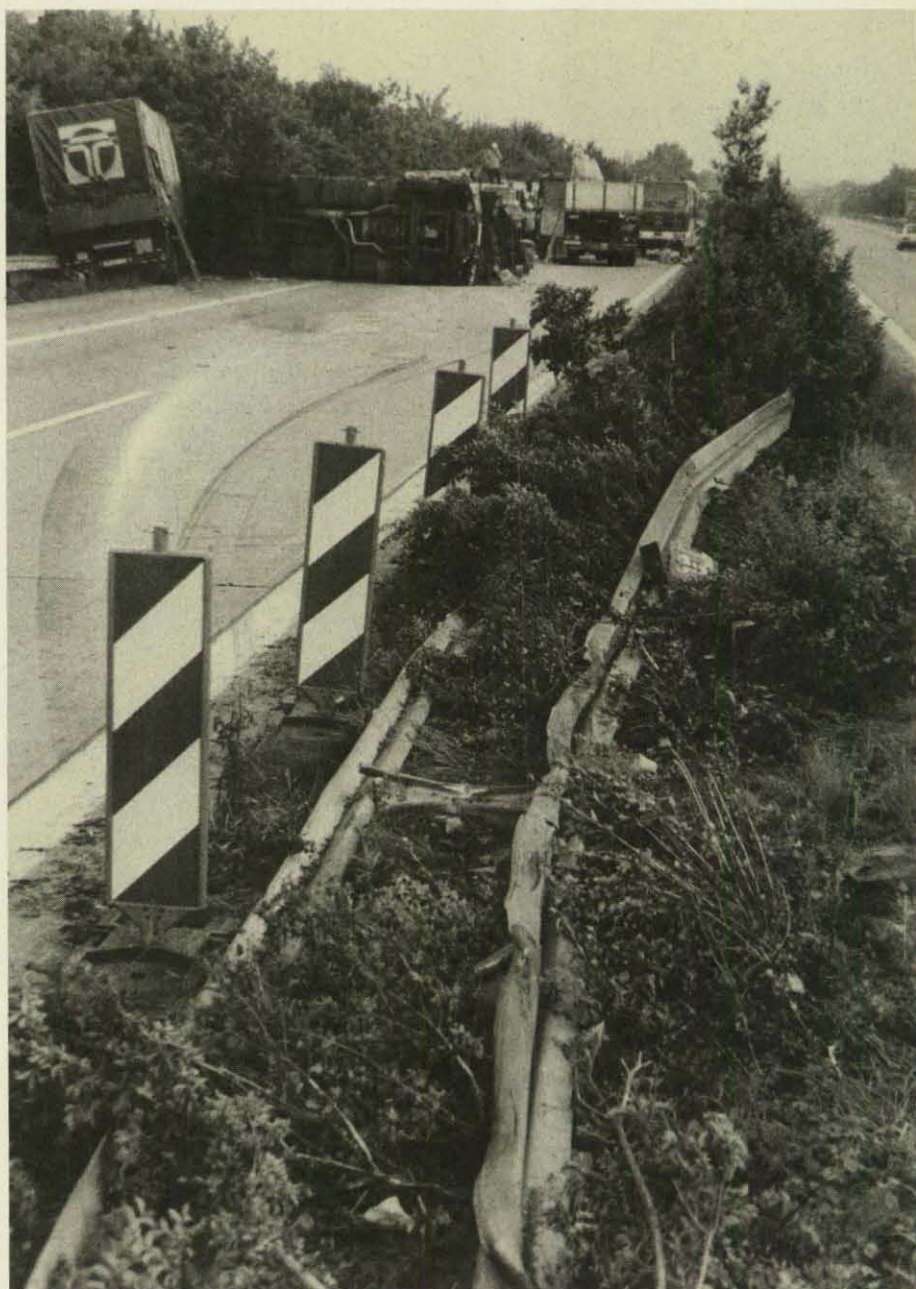
Nach Durchbrechen der Mittelleitplanke stürzt der Gefahrguttransporter auf der Gegenfahrbahn um.
