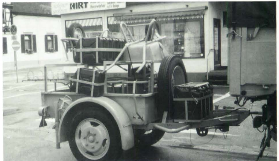
Dekontaminations-Anhänger des ABC-Zuges im Katastrophenschutz: Deutlich sichtbar sind die einzelnen Halterungen (Behältnisse) und die Verteilung der Geräte (Schubkarren u. a.).
