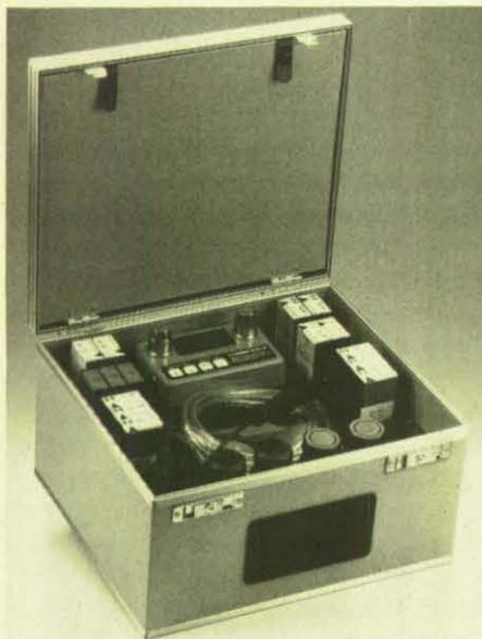
Combimeß-Koffer-Einheit ist mit modernen Geräten und Zubehör bestückt, durch die sinnvolle Schaumstoff-Einteilung ist ein schneller Zugriff gewährleistet. Genügend Raum zur Lagerung handelsüblicher Meßsysteme zur Erkennung schädlicher Stoffe (z. B. Prüfröhrchen-Meßgerät und max. 20 x 10 Röhrchen) ist vorhanden. Die Kofferabmessungen entsprechen der DIN-Norm zur Unterbringung in Feuerwehr-Fahrzeugen. (Foto: Interspiro)
