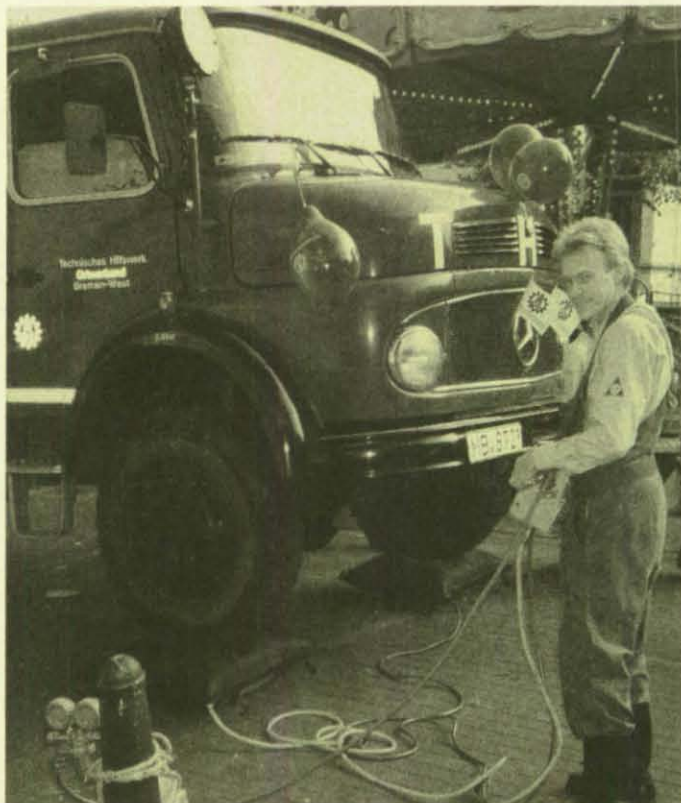
Mit dem Anheben des Fahrzeugs wird die Funktion der Hebekissen demonstriert. (Foto: Schüttpelz)
