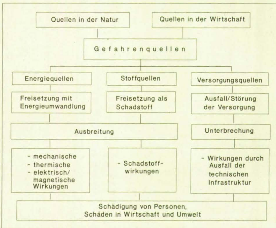
Bild 2: Zum Mechanismus destruktiver Wirkungen.
