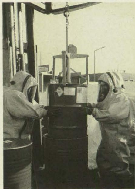
Öffnen, insbesondere auch beim Kran- bzw. Gabelstaplerbetrieb. Der TÜV-geprüfte Faßgreifer ist für eine Tragkraft von 400 kg ausgelegt und das geringe Eigengewicht sorgt für eine einfache und schnelle 1-Mann-Bedienung.
