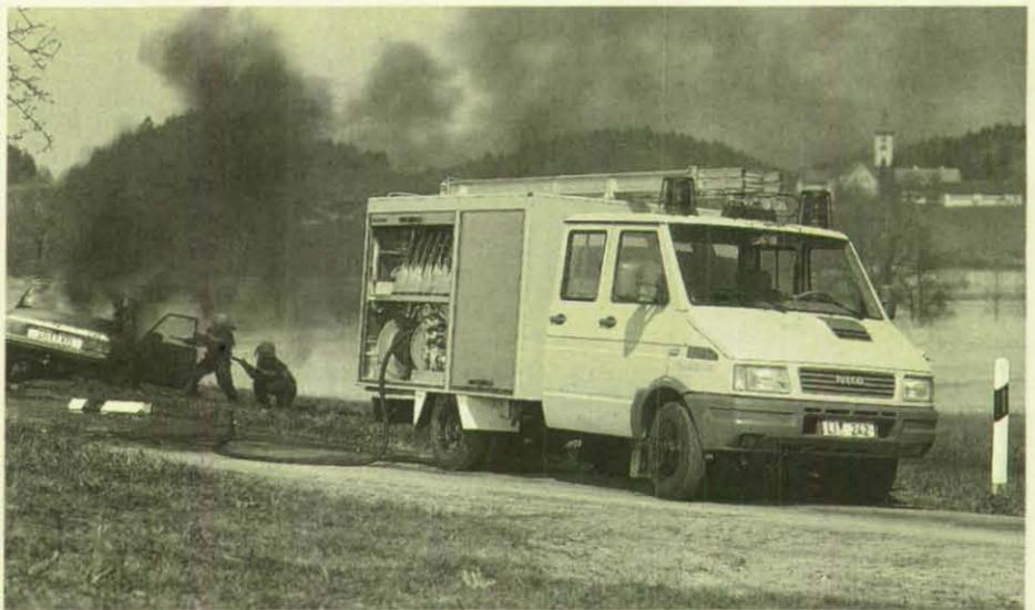
**Oben:** Das Tragkraftspritzenfahrzeug ist „erwachsen“ geworden: Mit Löschwasservorrat ein vollwertiges Löschfahrzeug.
