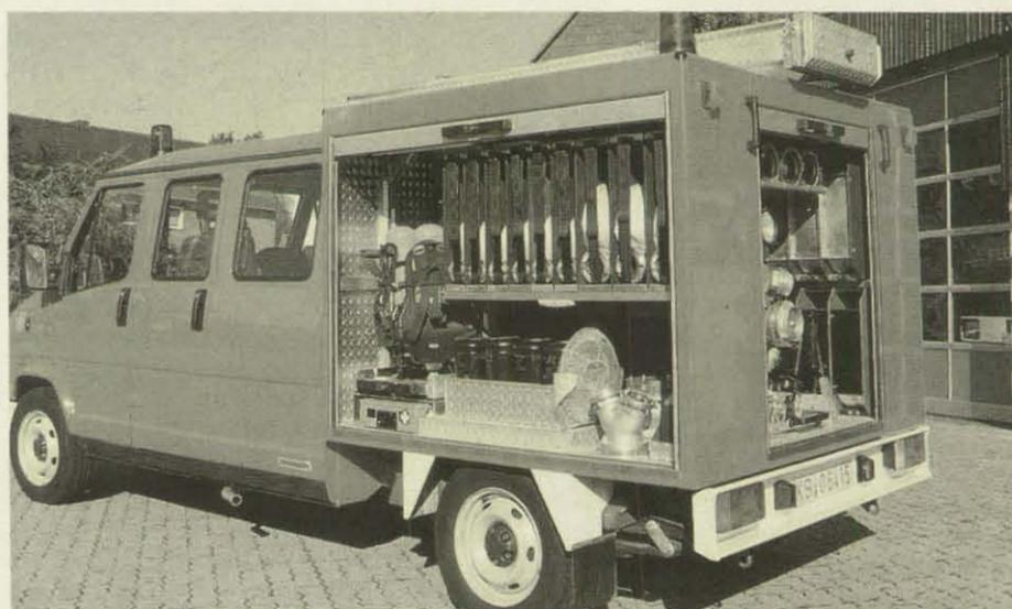
Besticht durch die räumliche Trennung der geräumigen Mannschaftskabine vom Geräteaufbau: Tragkraftspritzenfahrzeug auf Fiat-Ducato.
