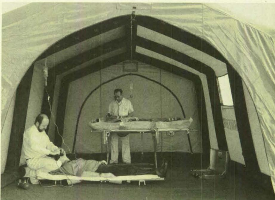
Schlauchgerüst, das mit wasserdicht beschichtetem Gewebe bespannt ist. Der Fußboden ist mittels Klettverschluß eingezogen und leicht herausnehmbar.
