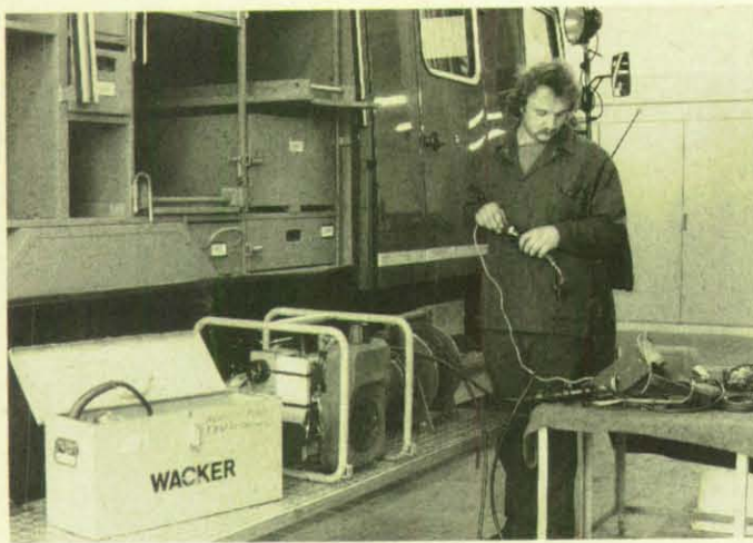
Die elektrische Ausstattung wird nach VDE 0100 überprüft.
