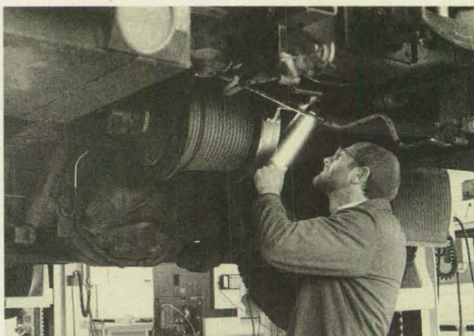
Gewissenhafte Kontrolle: Die Bremse der Seiltrommel wird überprüft.
