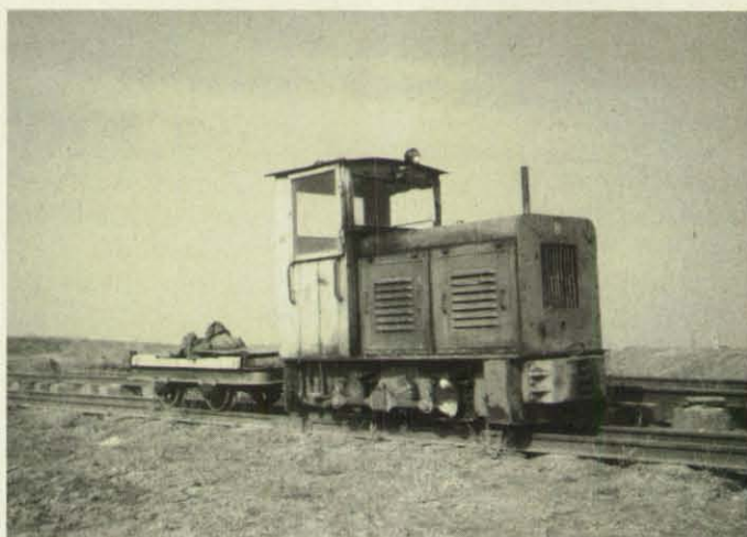
Bekommt bald eine neue Aufgabe: Die 22 kW (30 PS) starke Schmal-spur-Diesellokomotive aus Thüringen.
