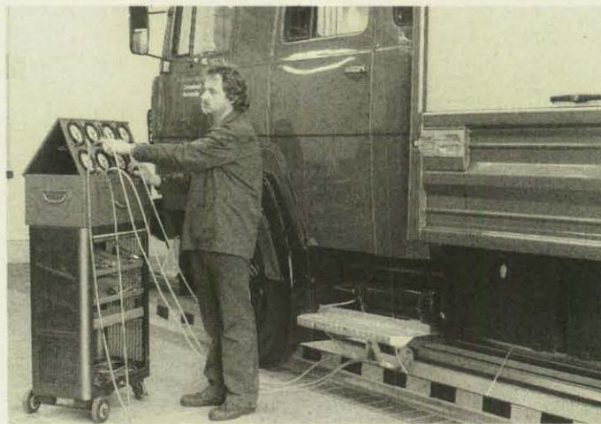
Zur Bremssonderuntersuchung (BSU) zählt auch die Überprüfung der einzelnen Druckluft-Bremsaggregate.
