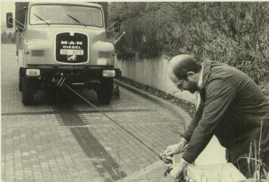
Vorbereitung zur Überprüfung der Seilwinde.
