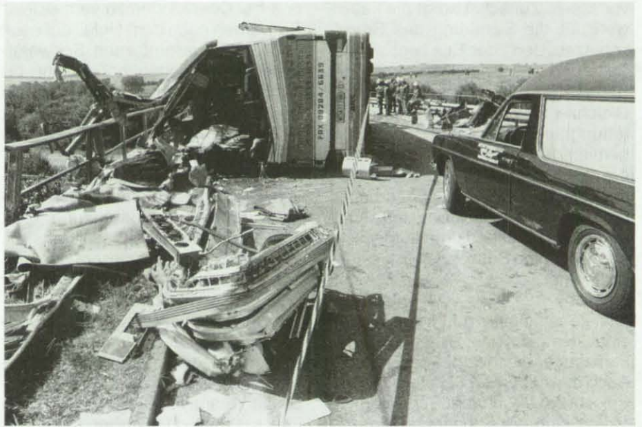
Beim schwersten Busunglück in Deutschland seit über 30 Jahren kommen 20 Menschen ums Leben. Eine Leitplanke, auf welche der Bus umstürzt, schlitzt diesen seitlich auf und dringt in den Innenraum ein. (Foto: dpa)
