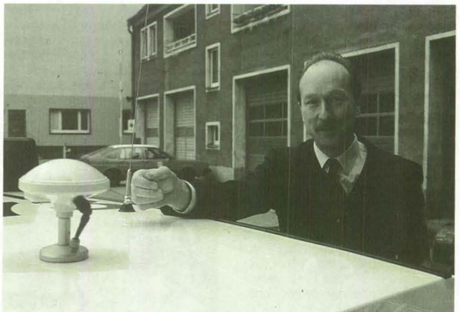
Diese Antenne auf dem Fahrzeugdach empfängt die Funksignale der Satelliten, die der GPS-Auswerter in Positionskoordinaten für das Ortungssystem VELOC umrechnet. Künftig sollen die Antennen so flach werden, daß sie in der Dachlackierung Platz finden.
