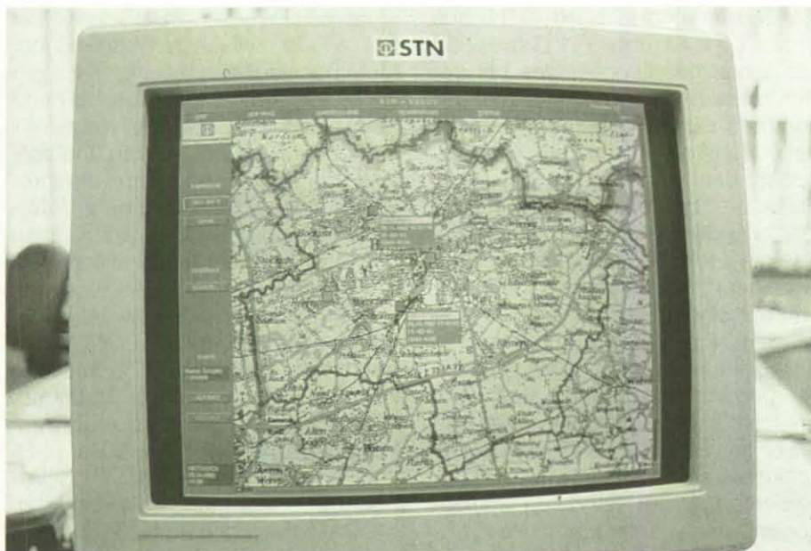
Eine von zwei Übersichtskarten im Maßstab 1:200 000, die in Hamm verwendet werden. Damit hat der Disponent in der Leitstelle einen Überblick über alle Fahrzeuge im Stadtgebiet, die mit VELOC ausgerüstet sind.
