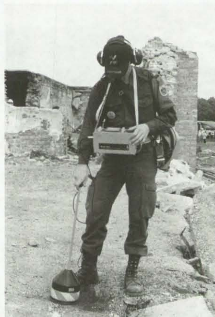
Das Ortungsgerät der österreichischen AFDRO-Einheit.
