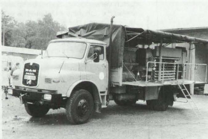
Dekontaminations-Mehrzweckfahrzeug (DMF) an der BKS in Heyrothsberge (Sachsen-Anhalt).
