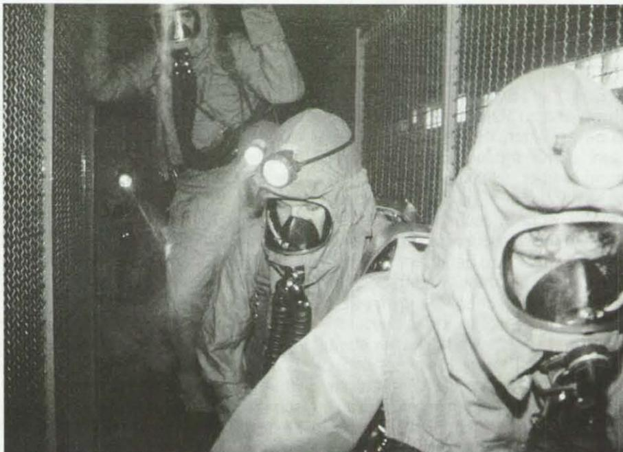
4,5 Kilogramm Schutzbekleidung und 12,5 Kilogramm Gerät hat jeder Grubenwehrmann zu tragen.
