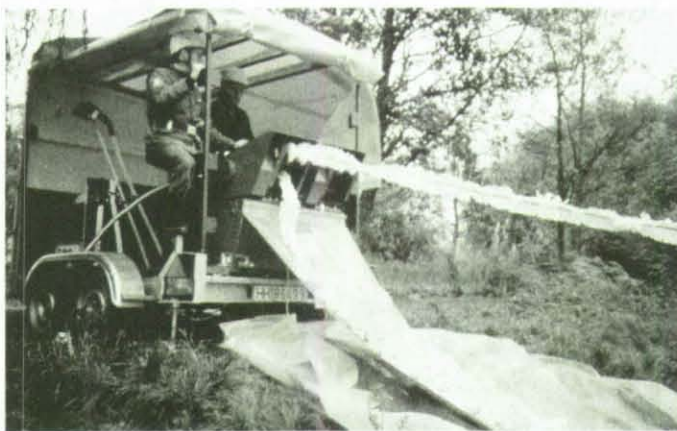
Auspressen des aufgesaugten Öls.
