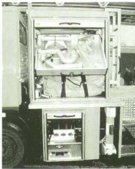
Im Gerätekofter sind auf der linken Seite ein Wenderohr sowie ein Sprungretter untergebracht. Im Fach unten Handscheinwerfer und Sanitätskasten.
