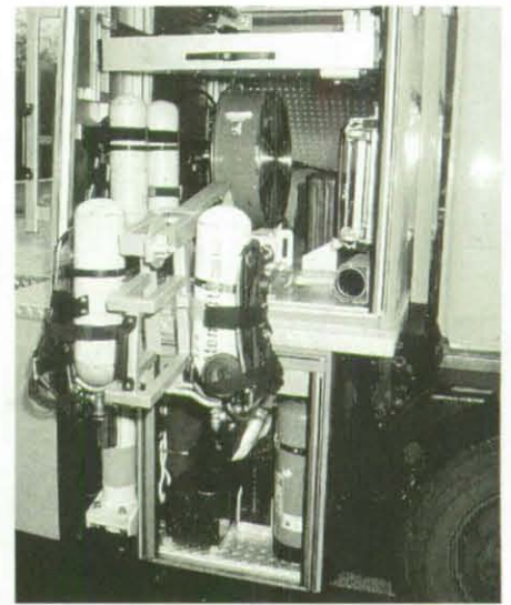
Die Halterung der beiden Preßluftatmer auf der rechten Fahrzeugseite kann ausgeklappt werden. Dann haben die Geräte die richtige Höhe zum Anlegen.
