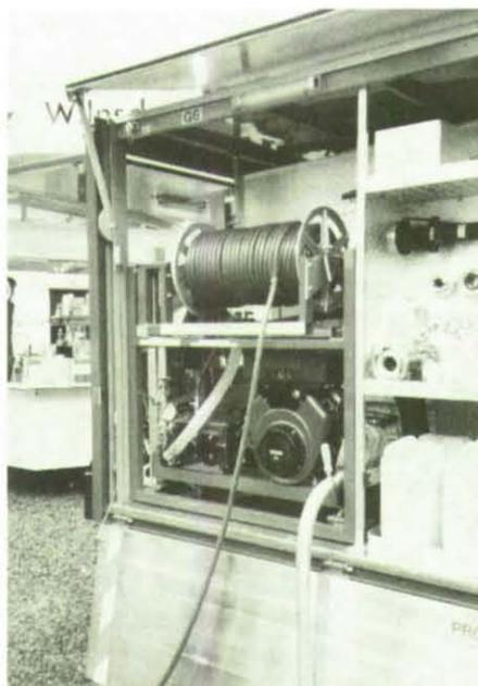
90 Meter Schlauch plus Hochdruckpumpe (unten) sorgen für Effektivität im Einsatz.
