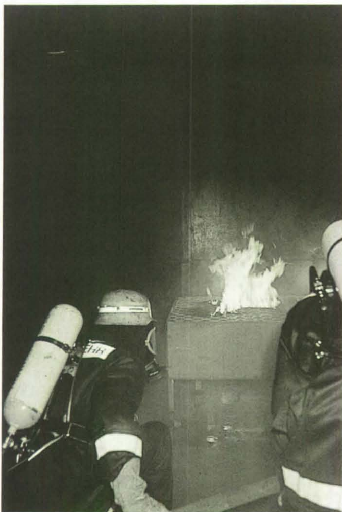
Dieses Metallgestell soll ein Doppelbett darstellen. Die Flammen können durch ein Computerprogramm größer oder kleiner gestellt werden.
