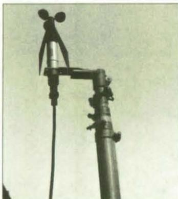
Die Windmeßanlage auf einem Schiebemast 8,5 Meter.
