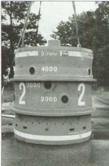
Der Löschwasserbehälter Smokey I mit einem Fassungsvermögen von 5000 Litern. Durch die zwölf Überlauföffnungen, die mit Gummistopfen verschließbar sind, kann die Füllmenge begrenzt werden.
