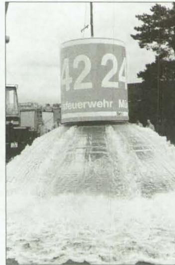
5000 Liter faßt der neue Löschwasserbehälter Semat F. Das Foto zeigt eindrucksvoll die gleichmäßig breitstreuende Wasserglocke, die durch das Anheben des gesamten Behältermantels erzielt wird.
