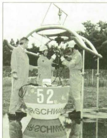
Mit dieser Eigenkonstruktion der Feuerweherschule üben die Lehrgangsteilnehmer, wie das Gurtgehänge in die unterschiedlichen Lasthaken eingehängt und die Steuerleitung gekuppelt wird.
