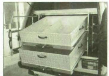
Der Geräteraum mit dem Schiebegerüst für Preßluftatmer und heraus-schwenkbare Schubkästen.
