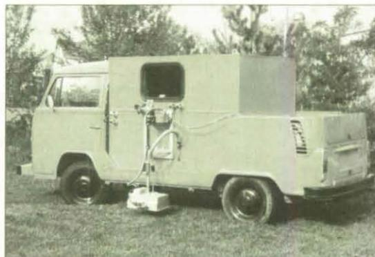
Foto 1: Der erste Prototyp aus dem Jahre 1980 mit gasbeheizter Sonde.
