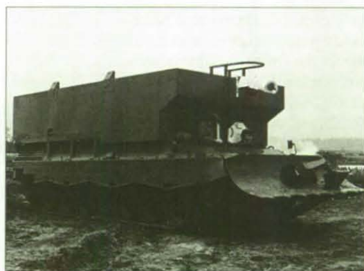
Das auf der Basis eines Fahrgestells des Kampfpanzers Leopard I entwickelte Hochleistungslöschfahrzeug PHF 15T.
