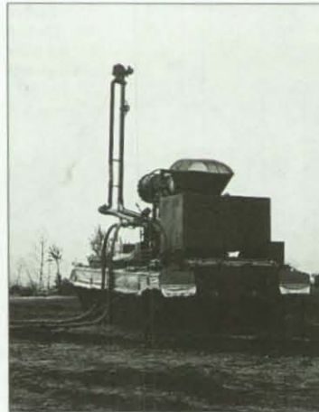
Das Löschwasser wird von oben in den Abgasstrahl eines Triebwerks – montiert auf einer Panzerlafette – „eingespritzt“.
