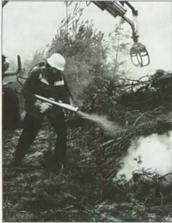
Innerhalb weniger Sekunden wird mit Hilfe eines Impulsgerätes das Brandgut mit Löschmittel beaufschlagt.
