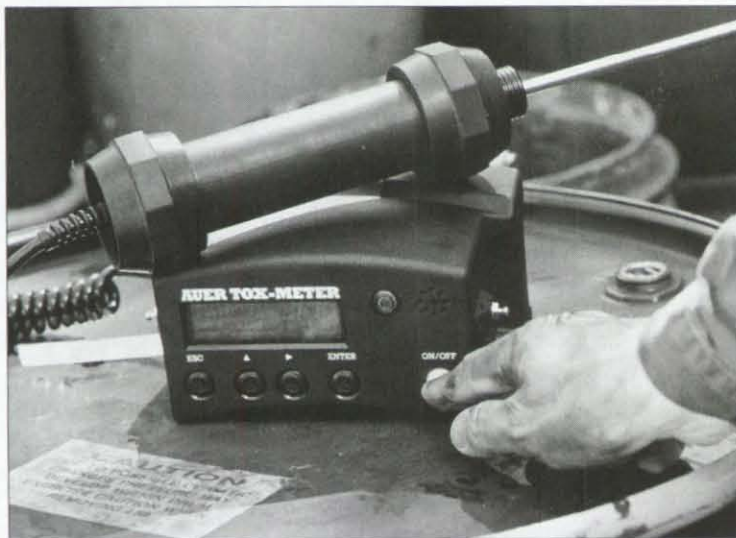
Die Messung toxischer Gase einfach aus der Hand, möglich mit dem Tox-Meter PID.
