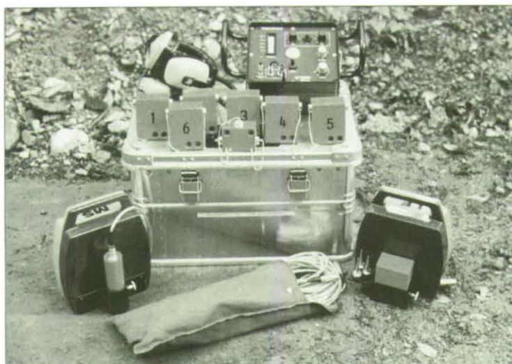
Oben: Eines der beiden akustischen Ortungsgeräte des THW mit Sensoren und Zubehör. Unten: Viel Erfahrung ist beim Auslegen der Sensoren nötig. (Fotos: Sers)
