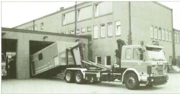
Oben: Glanzstücke der technischen Ausstattung: Ein Scania PM 93 6 x 2 A als Trägerfahrzeug für den Abrollbehälter Spüren und Messen. – Unten: Ein Teil der Abrollbehälter lagert auf dem Hof. (Fotos: Claes)
