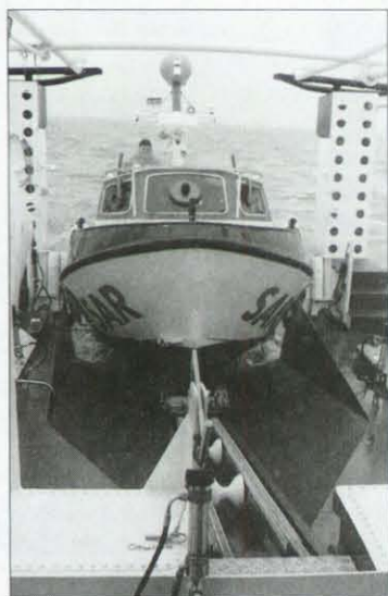
Die Rückkehr: Per Haken und Kettenzug findet das Tochterboot den Weg in die Heckwanne.
