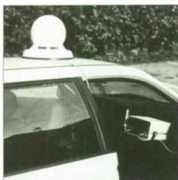
externe Geräte (Radio/Cassette/Funksprechgerät etc.), sowie ein Kommandomikrofon zur Textaufzeichnung und für Direktdurchsagen. Ein interner Kontroll-Lautsprecher ermöglicht das Abhören unabhängig vom Betrieb des Außenlautsprechers. Die Stromversorgung wird über den Zigarettenanzünder oder eine Norm-Bordsteckdose zugeführt.
