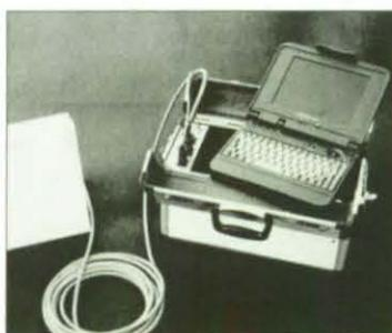
Dadurch, daß das Radarteil mit einer HF-Leistung von weniger als 4 mW auskommt, gilt das Gerät nicht als Sender, ist somit nicht zulassungspflichtig und völlig ungefährlich. Trotzdem können Bewegungen durch mehrere Steinmauern hindurch mit einer Detektionstiefe von 6 bis 10 m mit der Standardantenne detektiert werden. Für spezielle Anwendungsgebiete können mit Spezialantennen noch bessere Ergebnisse erzielt werden.
