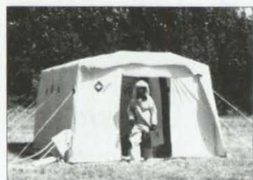
Hergestellt sind die Universalzelte aus dem reißfesten Material, das sich seit Jahren bei Hebekissen bewährt hat. Nur 1518 bzw. 1950 l Druckluft reichen aus, um das Zelt zu füllen. Ein Sicherheitsventil gewährleistet, daß der Betriebsdruck 0,5 bar nicht überschreiten kann. Mit Klettverschlüssen jeweils um eine Einheit verlängerbar, kann so eine größere Zeltanlage errichtet werden.
