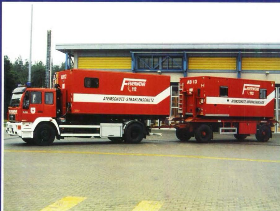
Weil an den Bau einer stationären Atemschutz-Übungsanlage derzeit nicht zu denken ist, ließen sich die Verantwortlichen der Landesfeuerwehrschule Brandenburg etwas einfallen: Sie konzipierten eine Übungsanlage, die in einen Abrollbehälter eingebaut ist. Obwohl die entsprechende DIN-Norm nicht hundertprozentig erreicht wird, erfüllt die Anlage ihren Zweck völlig. Seit Wochen wird das bei der Ausbildung der Atemschutzgeräteträger Tag für Tag unter Beweis gestellt.
