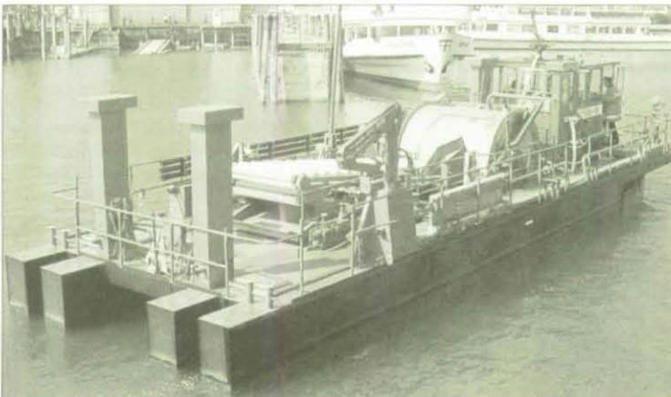
Das „Selbstfahrende Ölaufnahmegesetz (SÖG)“ der Ölwehr Friedrichshafen kann 15 Kubikmeter Öl-Wasser-Gemisch aufnehmen und mit der borbereiteten Pumpe wieder abgeben.
