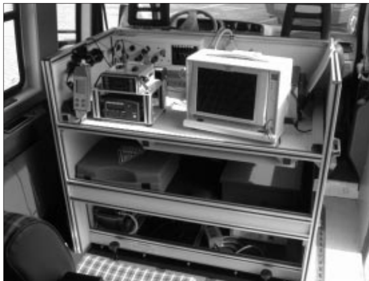
Die elektronische Meßeinheit ist das Herzstück des neuen Einsatzfahrzeugs. (Foto: Krapf)
