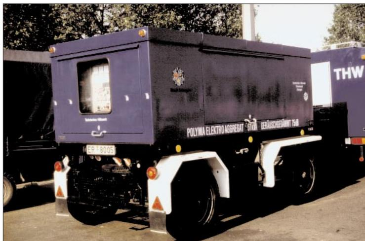
61-kVA-Aggregat des THW-Ortsverbands Erlangen von Polyma. Zur Beachtung: heckseitige Sichtscheibe, Reflektoren.
