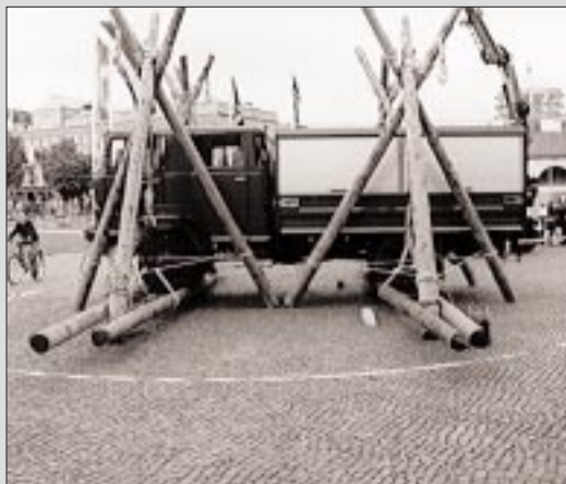
Das „schwebende Einsatzfahrzeug“ - mit vier Greifzügen angehoben. Ein vielbestaunter Beleg für das Können der THW-Helfer.
