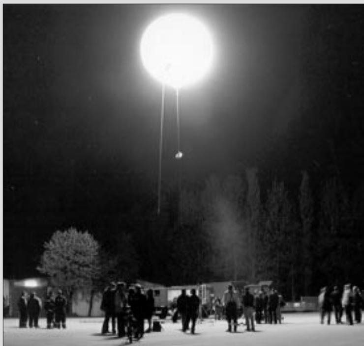
Der Leuchtballon wird als ein Modul des geplanten THW-Informations- und Hilfeleistungssystems potentiellen Anforderern angeboten. Das Modul Beleuchtung soll - mit seinem wichtigsten Bestandteil, dem Leuchtballon „Solarc 500-THW“ - bei Großschadensereignissen das Schadensgebiet effektiv und optimal ausleuchten.
