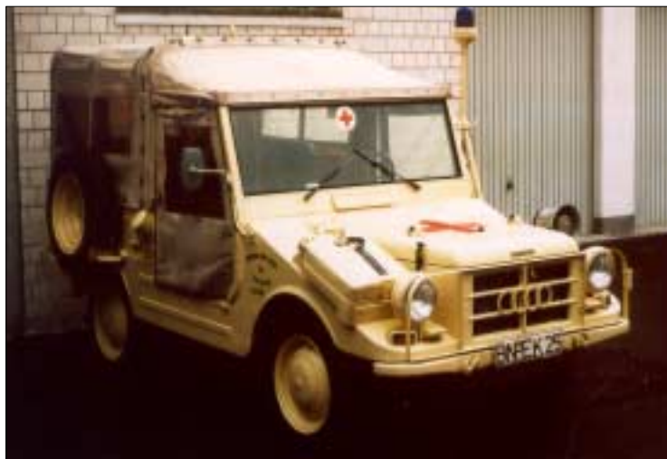
Der Munga 91/8: deutlich sichtbar verlängerter Aufbau, verkürzter Einstiegsbereich, Bedachung und Anbringung des Ersatzrades.
