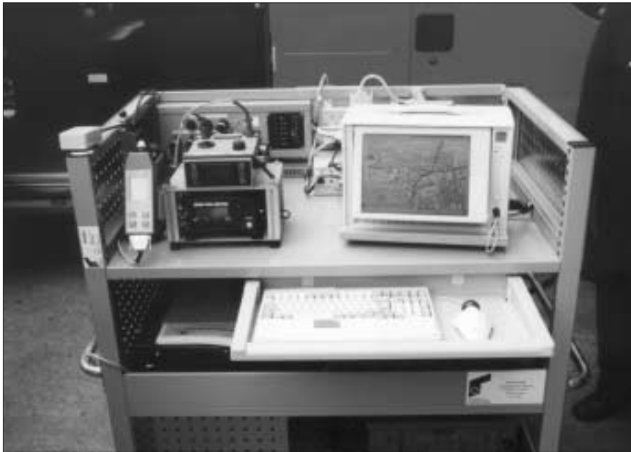
Der Messcontainer – in der Regel quer zur Fahrtrichtung hinter dem Fahrerteil angebracht – ist auch völlig vom Fahrzeug losgelöst einzusetzen, z. B. für stationäre Messaufgaben.
