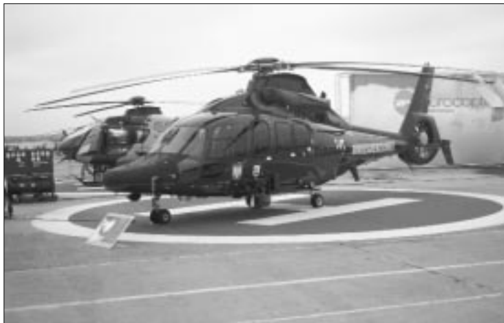
Die Polizei- und BGS-Hubschrauber (im Bild ein EC 155 des BGS) sind technisch ausgerüstet für die Aufgaben der Strafverfolgung und der Luftraumüberwachung bzw. der Grenzkontrolle mit hochauflösenden Kameras sowie Infrarot- und Radarsystemen.
