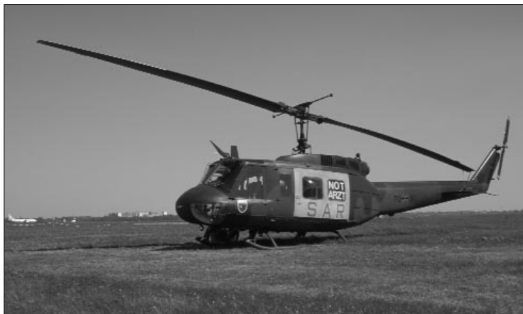
Bell UH-1D; dieser Hubschraubertyp hat nur eine Turbine und entspricht nicht mehr den Richtlinien (JAR-OPS 3) der Luftrettung; er ist bis Ende 2009 zu ersetzen.
