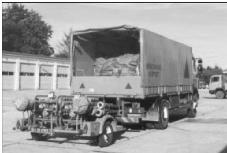
Anders als in Deutschland wird das Material des Schlauchwagens in Säcken verstaut; ebenfalls unbekannt ist hierzulande der Anhänger mit zwei offen nebeneinanderstehenden Tragkraftspritzen.
