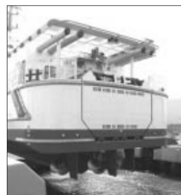
Die besondere Konstruktion des Rumpfes im Heckbereich soll u.a. das Seegangsverhalten positiv beeinflussen. (Foto: DGzRS)
