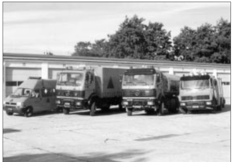
Die Ausrückewache besteht aus Kommunikationswagen, Schlauchgruppenwagen mit TSA, Wassertankwagen und Automobilspritze mit Hochdruckkompressor-Anhänger.
