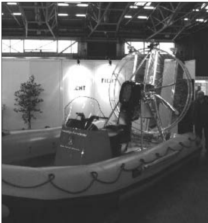
Mit dem Bootsantrieb per Luftschraube ist die Feuerwehr auch bei Hochwasser ohne Angst vor Treibgut einsatzbereit. (Fotos: Paul Claes)
