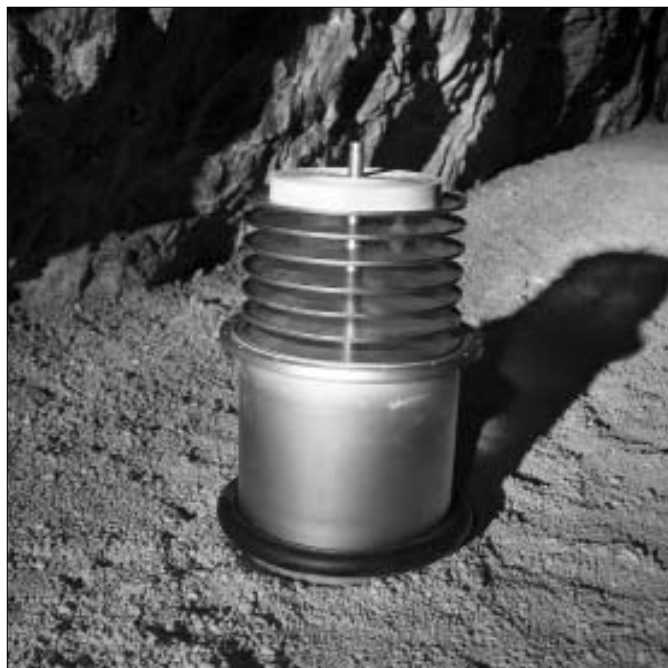
In derzeit 1550 luftdichten Edelstahlbehältern (oben) lagern auf Spezialhalterungen (unten) insgesamt etwa 25.000 Kilometer Mikrofilm. (Fotos: ZfZ)
