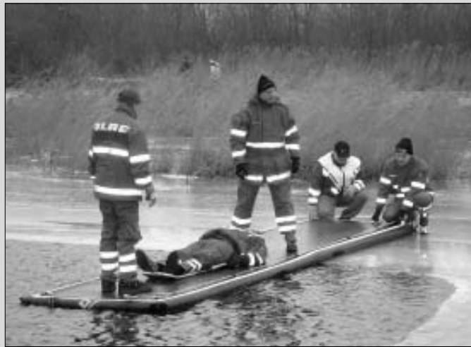
Allrounder: der Rettungssteg ist auch im Wasser, in Sümpfen und anderen instabilen Untergründen einsetzbar.
