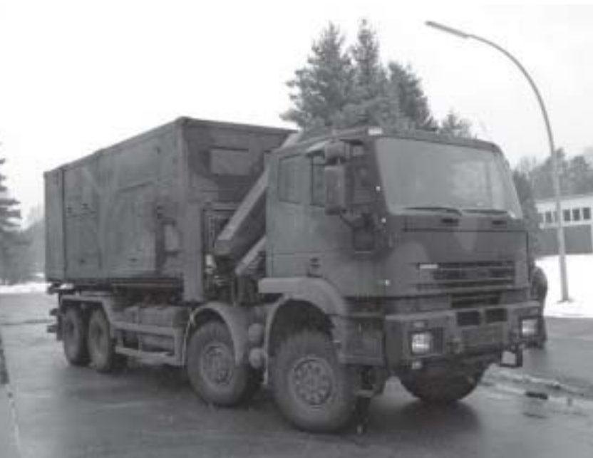
Dekontaminationsausstattung TEP 90 (Truppenentgiftungs-, Entseuchungs-, Entwesungs-, Entstrahlungsplatz 90). (Fotos: Autoren)
