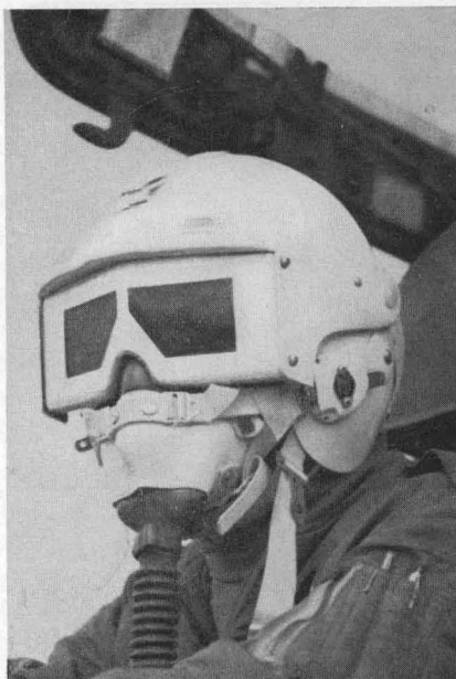
Photochromic Goggle der Firma EG & G in einem Pilotenhelm eingearbeitet.
