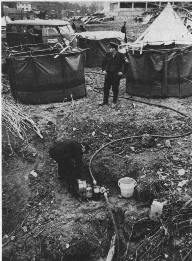
Eine Wasseraufbereitungsanlage des Technischen Hilfswerks. 4—6000 Liter reines Trinkwasser werden pro Stunde geliefert bei drei Mann Bedienungspersonal.
